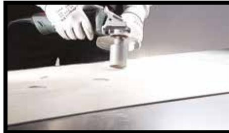
**Fig.9/10** - Como alternativa es posible utilizar brocas de corona (o perforadoras) montadas en esmeriladoras, taladros o atornilladores eléctricos.
