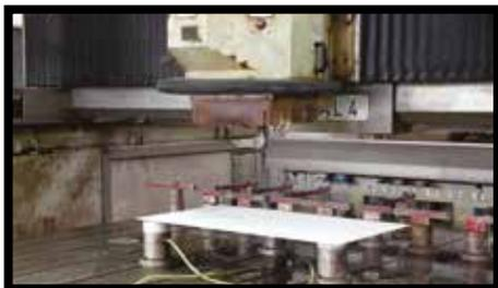
**Fig.16** - KERLITE, en todas sus variedades, se pueden cortar incluso utilizando máquinas de control numérico. La fresa para estas máquinas requiere una velocidad de rotación de entre 12000 y 18000 rpm, con una velocidad de avance de 0,5 a 1 m/min.
