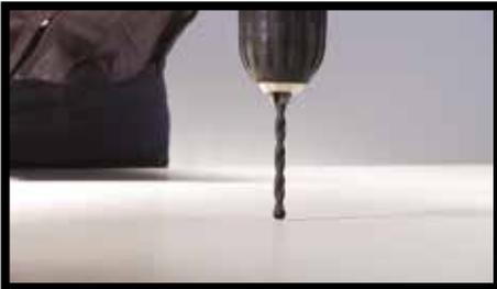
**Fig.8** - Para la perforación manual se pueden utilizar puntas de tungsteno de hasta 10 mm de diámetro montadas en taladros o atornilladores eléctricos.
