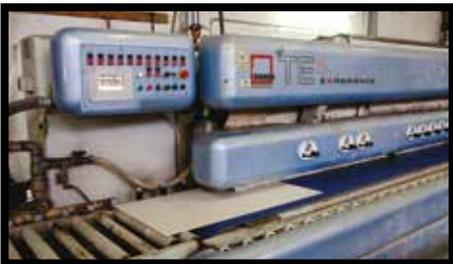
**Fig.20** - Para la formación y el pulido del canto es necesario utilizar muelas diamantadas y abrasivas con el fin de obtener un canto con la medida y la forma requeridas. Para ello se utilizará una muela pulidora. Es posible obtener numerosos acabados de canto utilizando diferentes muelas. La velocidad operativa se debe probar previamente.
