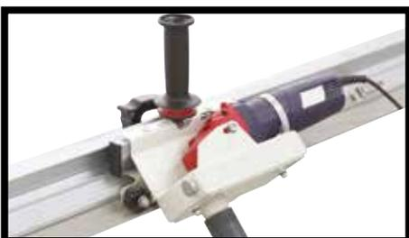
**Fig.6** - Con la regla para el cortador de láminas es posible utilizar esmeriladoras manuales insertadas en una estructura adecuada que se enfila sobre la guía de corte. De esta manera, se pueden realizar cortes de 90° a 45° para obtener biselados y comodines.
