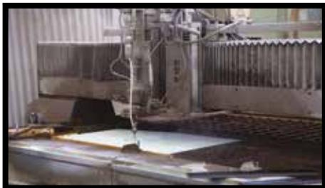
**Fig.17** - KERLITE, en todas sus variedades, se puede cortar también utilizando máquinas de chorro de agua. Recomendamos utilizar una velocidad operativa de entre 2 y 3 m/min.
