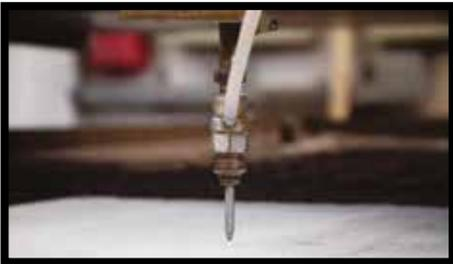
**Fig.19** - KERLITE, en todas sus variedades, puede perforarse incluso utilizando máquinas de chorro de agua.
