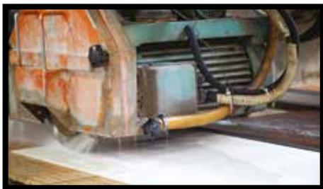
**Fig.15** - KERLITE, en todas sus variedades, puede cortarse utilizando discos diamantados. Los discos deben ser para gres porcelánico y estar en buenas condiciones. Se recomienda proceder con velocidades de rotación altas (>2000 rpm) y velocidades de avance de entre 0,5 y 1 m/min. Según el tipo de disco y la longitud del corte, puede ser necesario el enfriamiento del disco con agua.
