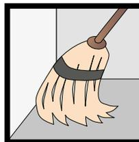
**Fig.26** - La superficie de soporte debe estar limpia. El polvo, los aceites, las grasas, la suciedad y los residuos se deben eliminar ya que pueden comprometer la adhesión de la cola.
