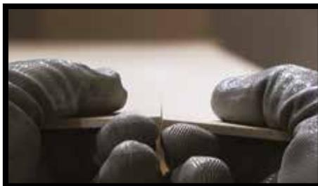
**Fig.3** - Tras realizar la incisión, tan sólo es necesaria una simple flexión para separar las dos piezas.
