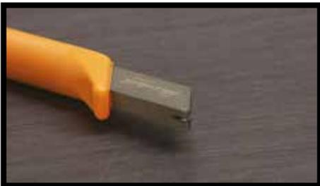
**Fig.1** - Es posible obtener excelentes cortes y perfilados realizando incisiones sobre cualquier tipo de KERLITE con cortadores de vidrio tipo Silberschnitt 2000, un cortador de vidrio especial de **Bohle Italia** o con cortadores de láminas manuales de **Würth**. Para realizar el corte es importante no separar el cortador de vidrio del eje de corte durante toda la operación de trabajo.
