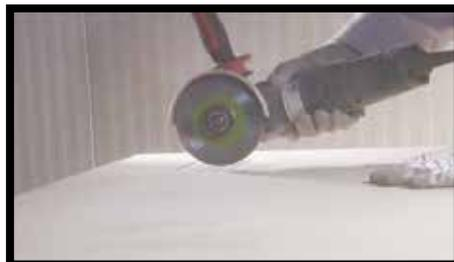
**Fig.13** - Es posible también obtener los mismos resultados con discos de lijado utilizados con una esmeriladora manual.
