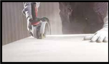
**Fig.7** - KERLITE, en todas sus variedades, se puede cortar incluso empleando esmeriladoras manuales eléctricas con discos diamantados. Es necesario aplicar altas velocidades de rotación
