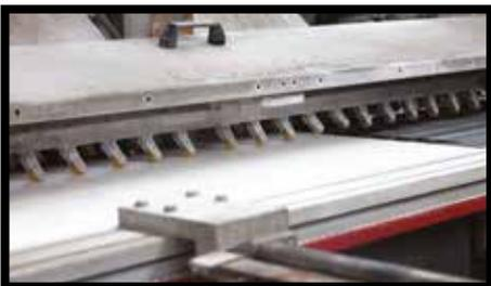
**Fig.21** - Para realizar un corte de 45° se pueden utilizar discos diamantados con una inclinación de 45°. De esta manera es posible realizar un canto con dos láminas de KERLITE de cualquier tipología. Luego el canto se deberá biselar. Es posible obtener numerosos acabados de canto utilizando diferentes muelas. La velocidad operativa se debe probar previamente.
