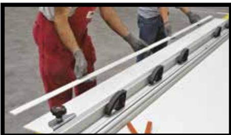
**Fig.5** - Una herramienta práctica para realizar los cortes es la regla para cortador de láminas (tipo Keracut de **Sigma** o Free-cut de **Raimondi**). En el caso de las variedades KERLITE 3PLUS y KERLITE 5PLUS, también utilizando este instrumento, una vez se haya realizado la incisión en la parte cerámica y la placa se haya separado, el corte se completará cortando la fibra de vidrio con un cúter convencional.(**Fig.4**).
